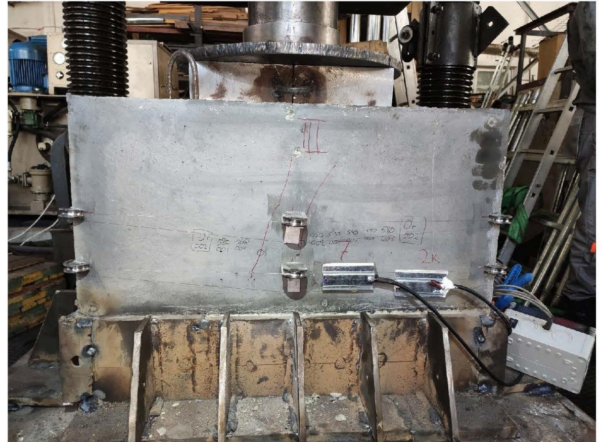
ИСПЫТАНИЯ ПОДФЕРМЕННИКА ИЗ СПФБ
