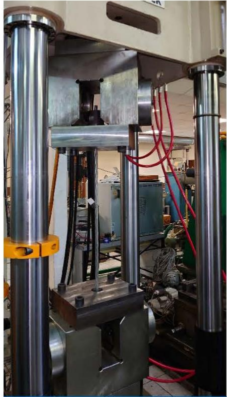
ИСПЫТАНИЯ ОТЕЧЕСТВЕННОГО ВАНТОВОГО КАНАТА НА ВЫНОСЛИВОСТЬ
