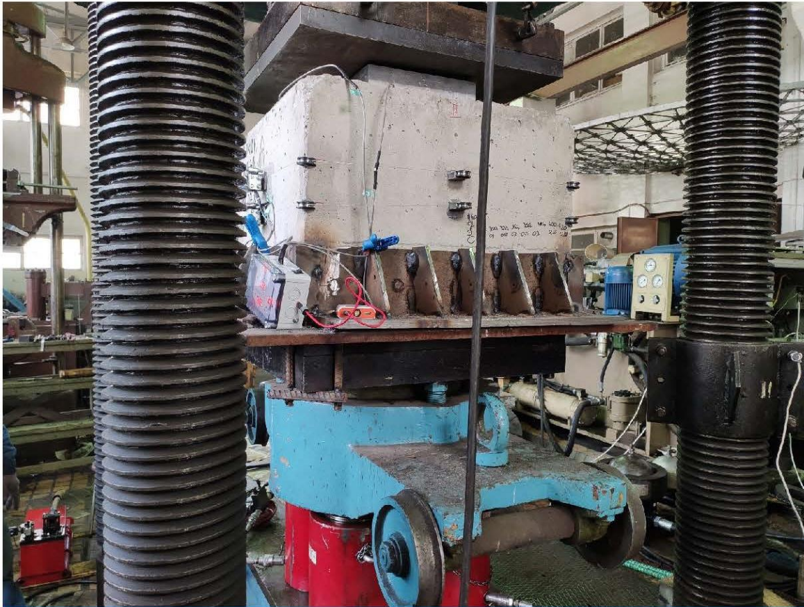
ПРОЦЕСС ИСПЫТАНИЯ ЖЕЛЕЗОБЕТОННОГО ПОДФЕРМЕННИКА С ОДНИМ ИЗ ВАРИАНТОВ АРМИРОВАНИЯ
