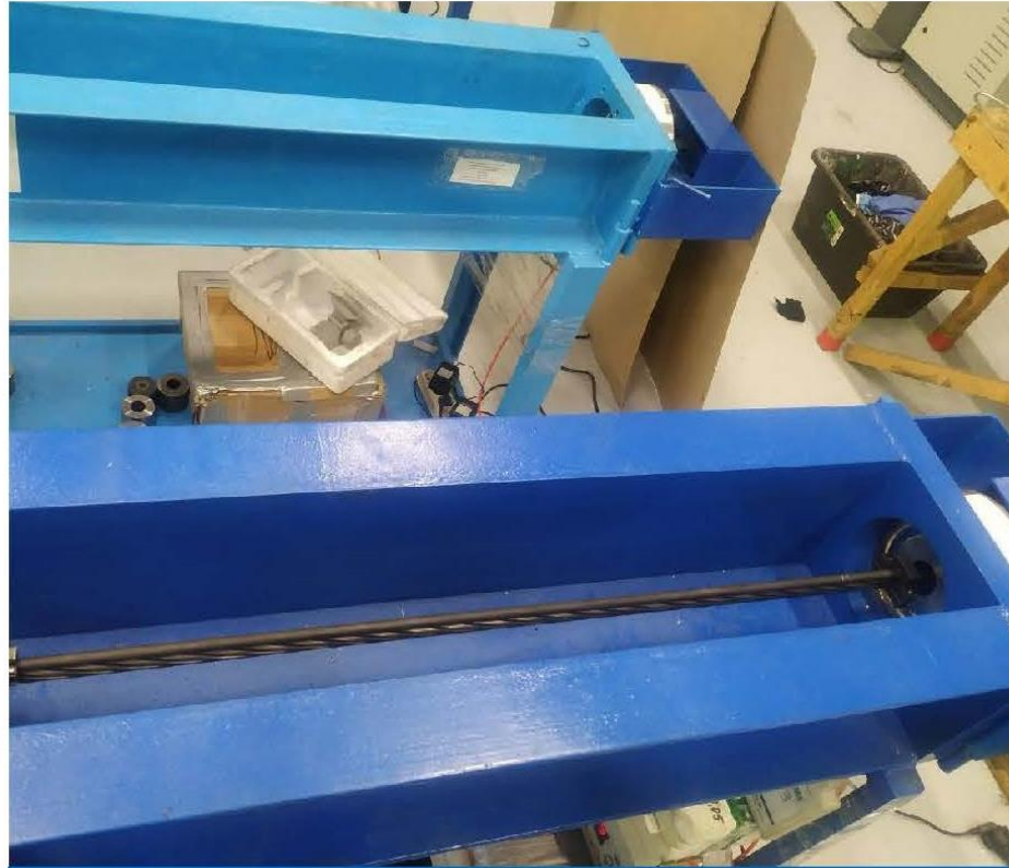
ИСПЫТАНИЯ ОТЕЧЕСТВЕННОГО ВАНТОВОГО КАНАТА НА РЕЛАКСАЦИЮ
