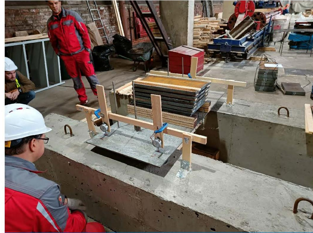
ИСПЫТАНИЯ ЭЛЕМЕНТА КОНСТРУКЦИИ ИЗ СПФБ
